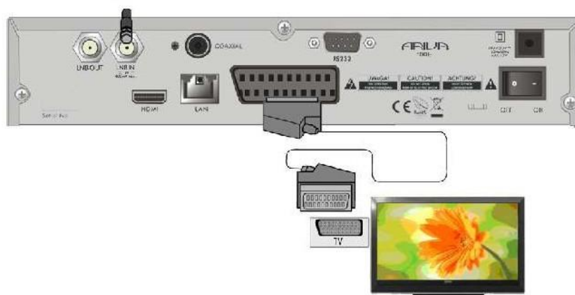
Rysunek 1. Schemat połączenia tunera satelitarnego z OTVC:
